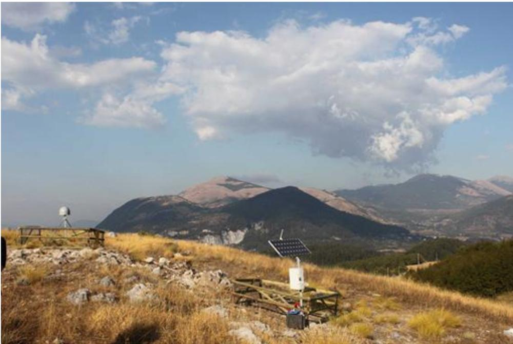
Figura 1 – Stazione GPS della rete RING di Mormanno (Cosenza) (fonte: <http://ring.gm.ingv.it>).
