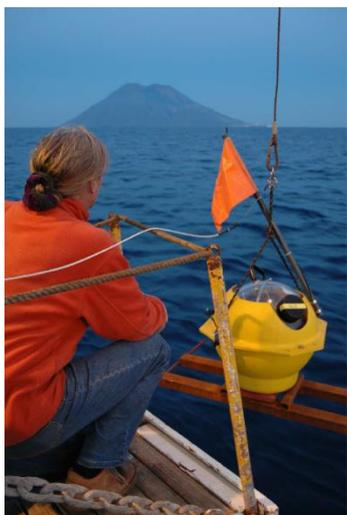
**Foto 4** – Fase di rilascio di un OBS (Ocean-Bottom Seismometers)
