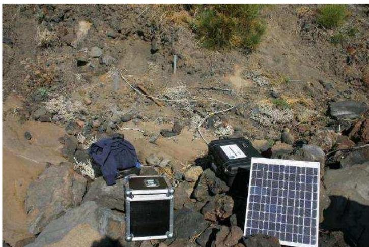
**Foto 3** – Stazione sismica mobile (Osservatorio Etneo, INGV)
