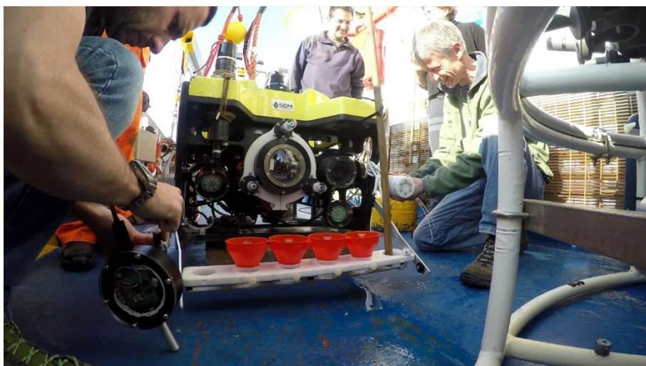
Foto1. ROV (veicolo subacqueo filoguidato) con sonda per misurare temperatura e prototipo per campionare gas realizzato dai ricercatori dell'INGV di Palermo montato su ROV
